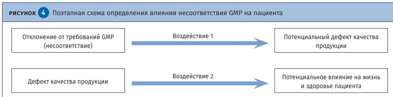
несоответствия необходимо определить два характера воздействия (влияния) (рис. 4).
