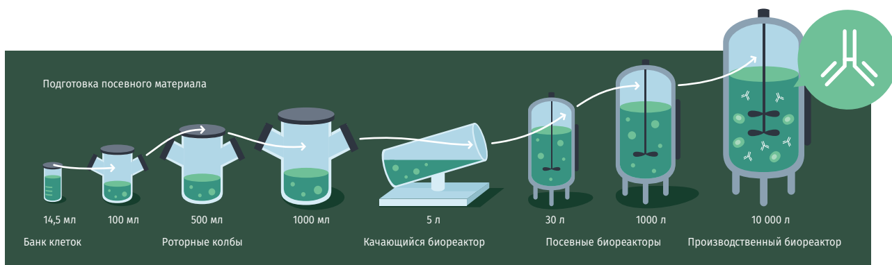
РИСУНОК 2. Вышестоящий процесс. Предусматривает наращивание клеток СНО для биосинтеза моноклонального антитела в больших объемах в производственном биореакторе
